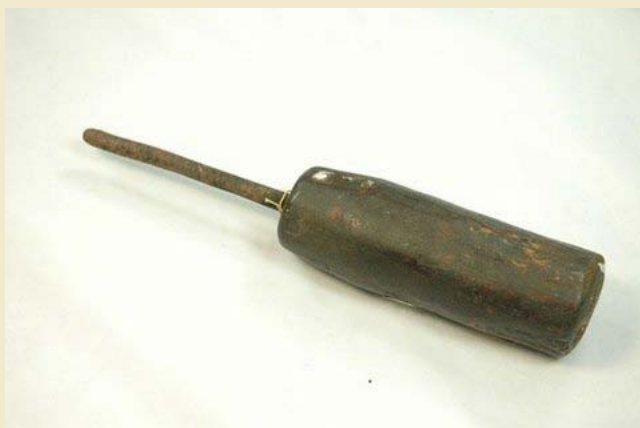
鐵孔器：此鐵孔器即為鑽木釘接孔以密合船板之間縫隙所用之工具。
