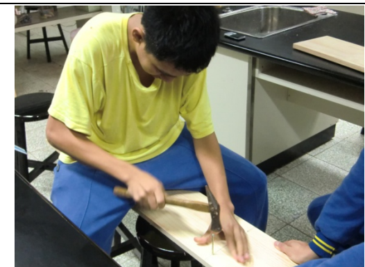
b. 以釘子為彈力柱及固定座的定位
